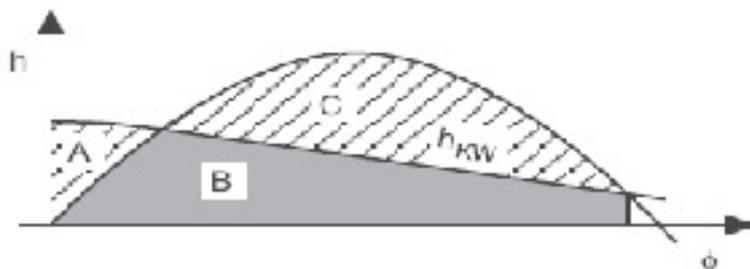
$h_{KW}$  = Kurve der krängenden Hebelarme infolge seitlichen Winddrucks
